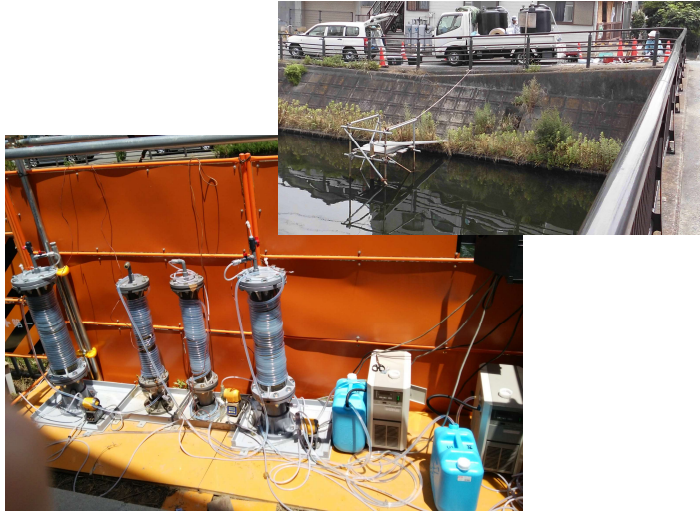
微生物と養分を注入による浄化促進試験
